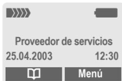
En cuanto aparece el nombre del proveedor en el display, el teléfono se encuentra en **estado de espera a llamada** y **listo para el servicio**. Si cierra ahora la pieza deslizante, el teléfono permanece en estado de espera a llamada.
